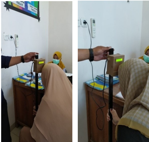
Gambar 14. Hasil Uji Coba Sensor AMG8833 Melalui Bagian Dahi
